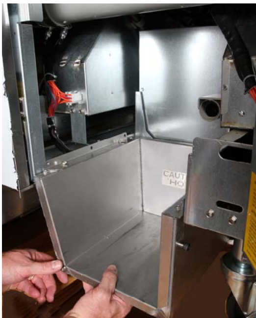
Figure 2 : Placez le bac de fusion.
